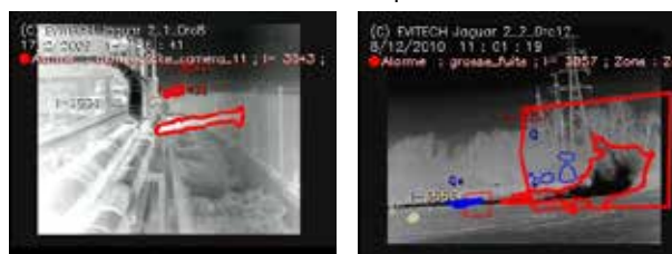
détection feux / Hydrocarbures
