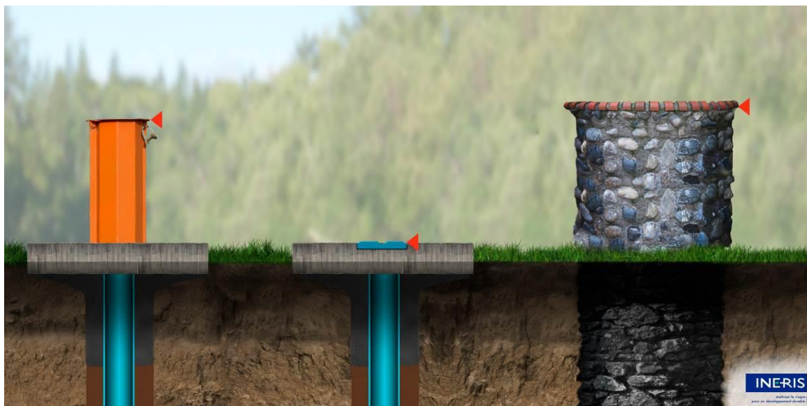
Figure 25 : Point de mesure de la piézométrie pour les différents forages du réseau de surveillance (repère altimétrique, recommandé en m NGF).
