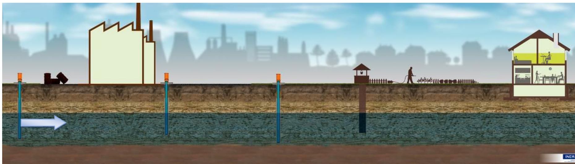
Figure 24 : Schéma conceptuel hydrodynamique et réseau de surveillance (cas d'un suivi préventif, en l'absence de pollution du milieu eau souterraine, la flèche indique le sens d'écoulement).
